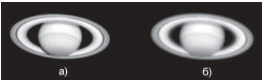
Рис. 9.7. Знімок Сатурна із Землі: а — з адаптивною оптикою, б — зроблений традиційним способом
